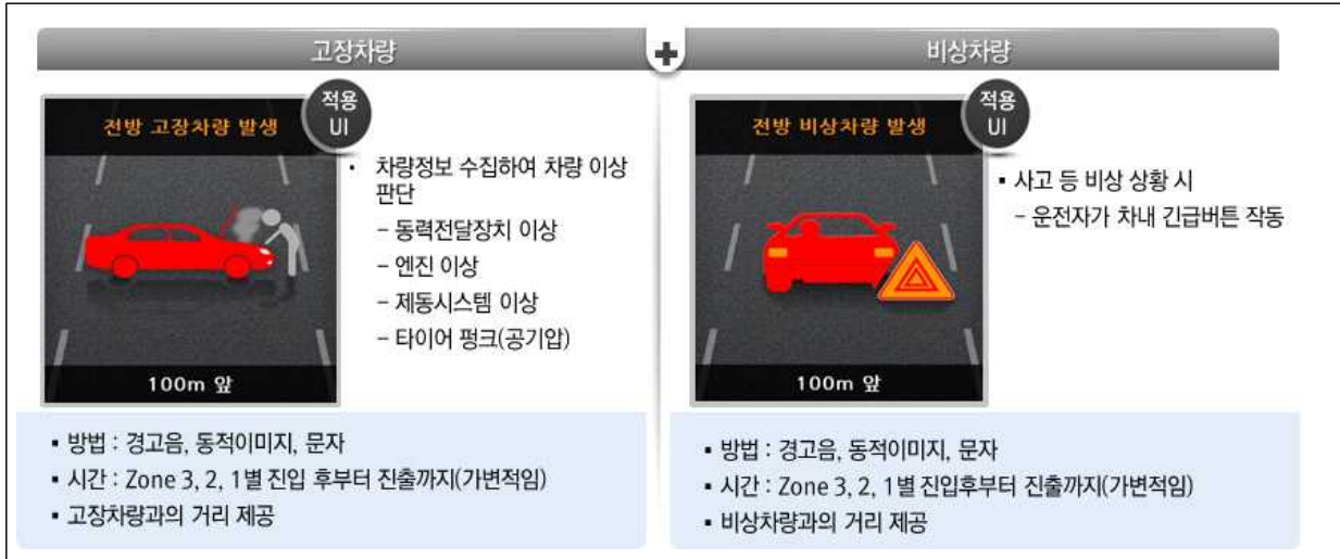
<그림 3-29> 차량 긴급상황 경고 시스템 개념도
