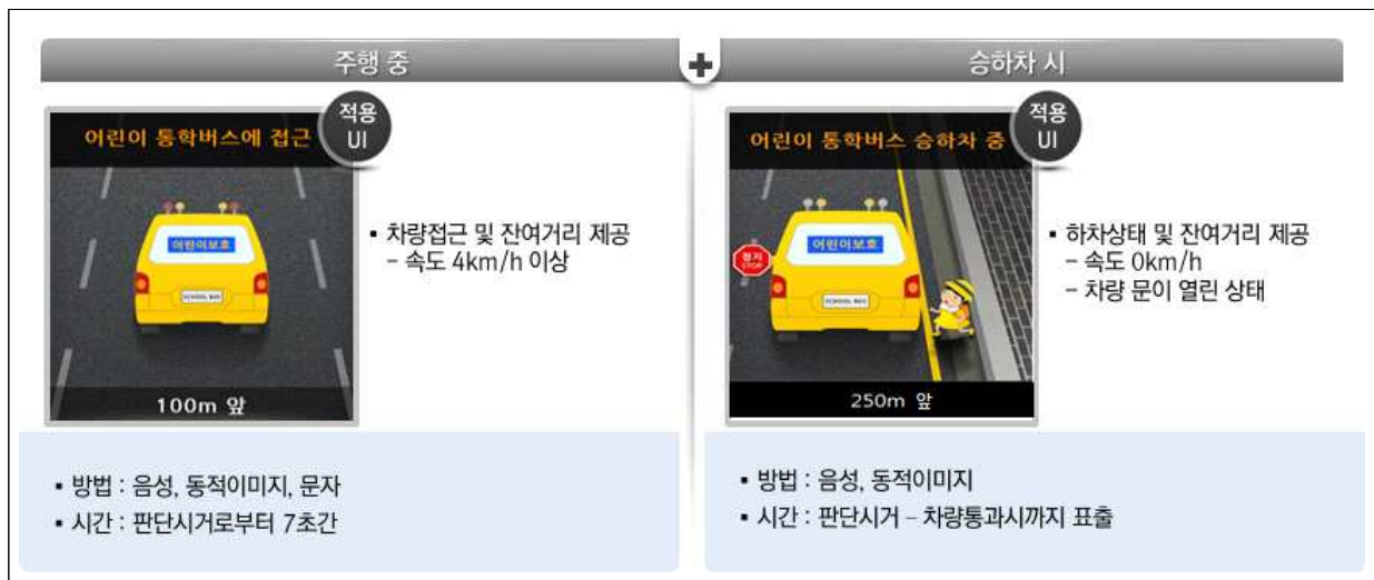
<그림 3-24> 옐로우 버스 운행 안내 시스템 개념도
