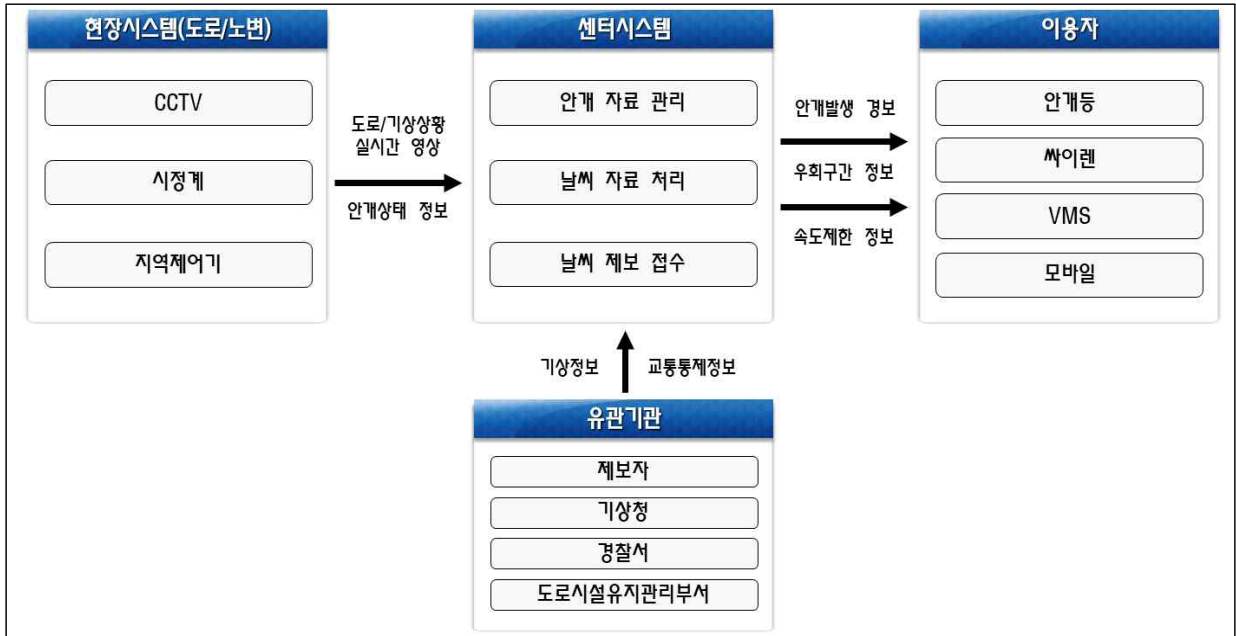
<그림 5-51> 안개대응시스템 구성체계
