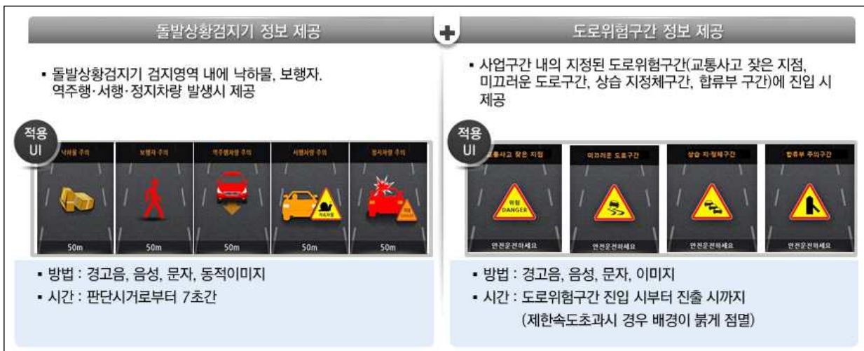
<그림 3-18> 도로 위험구간 정보제공 시스템 개념도
