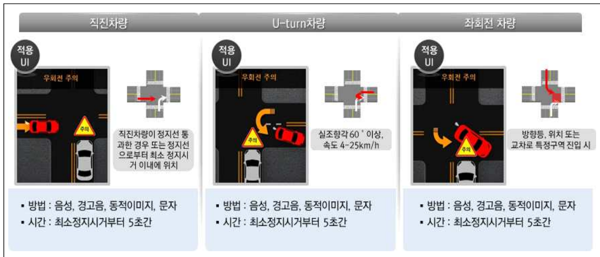
<그림 3-22> 우회전 안전운행 지원 시스템 개념도
