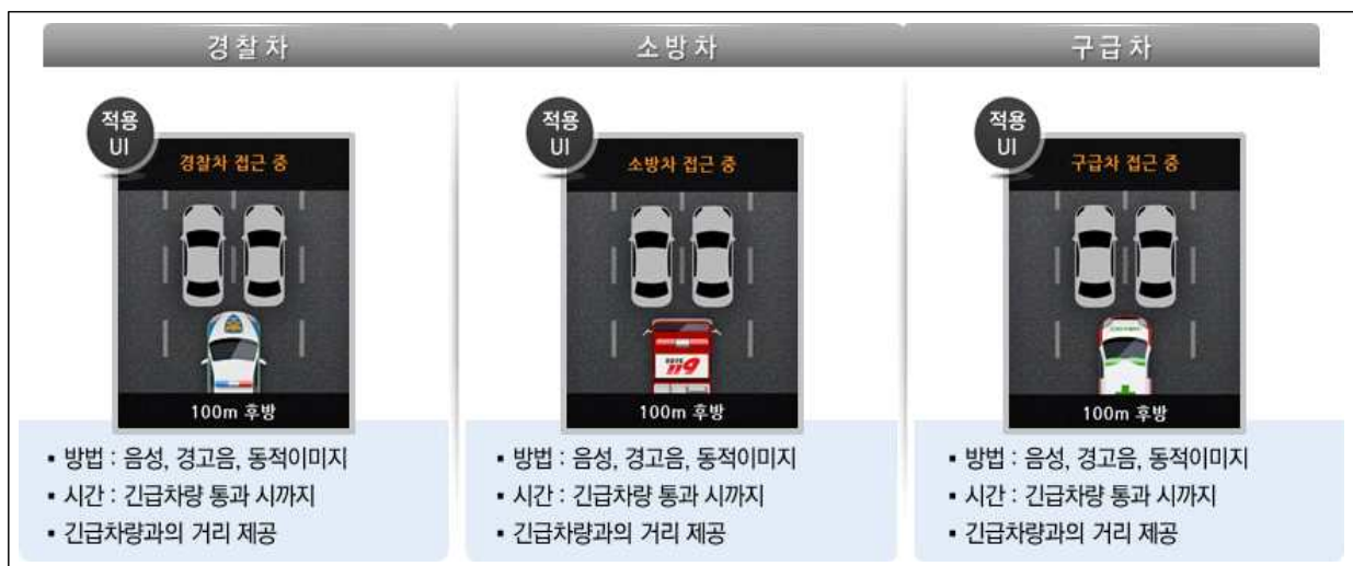
<그림 3-28> 긴급차량 접근 경고 시스템 개념도
