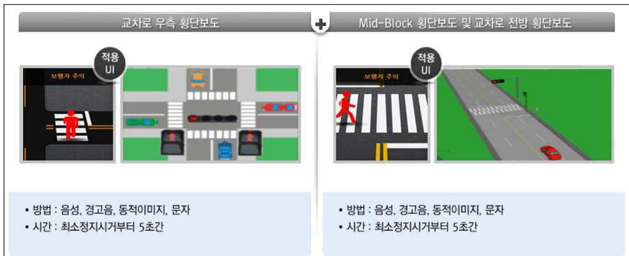
<그림 3-26> 보행자 충돌방지 경고 시스템 개념도
