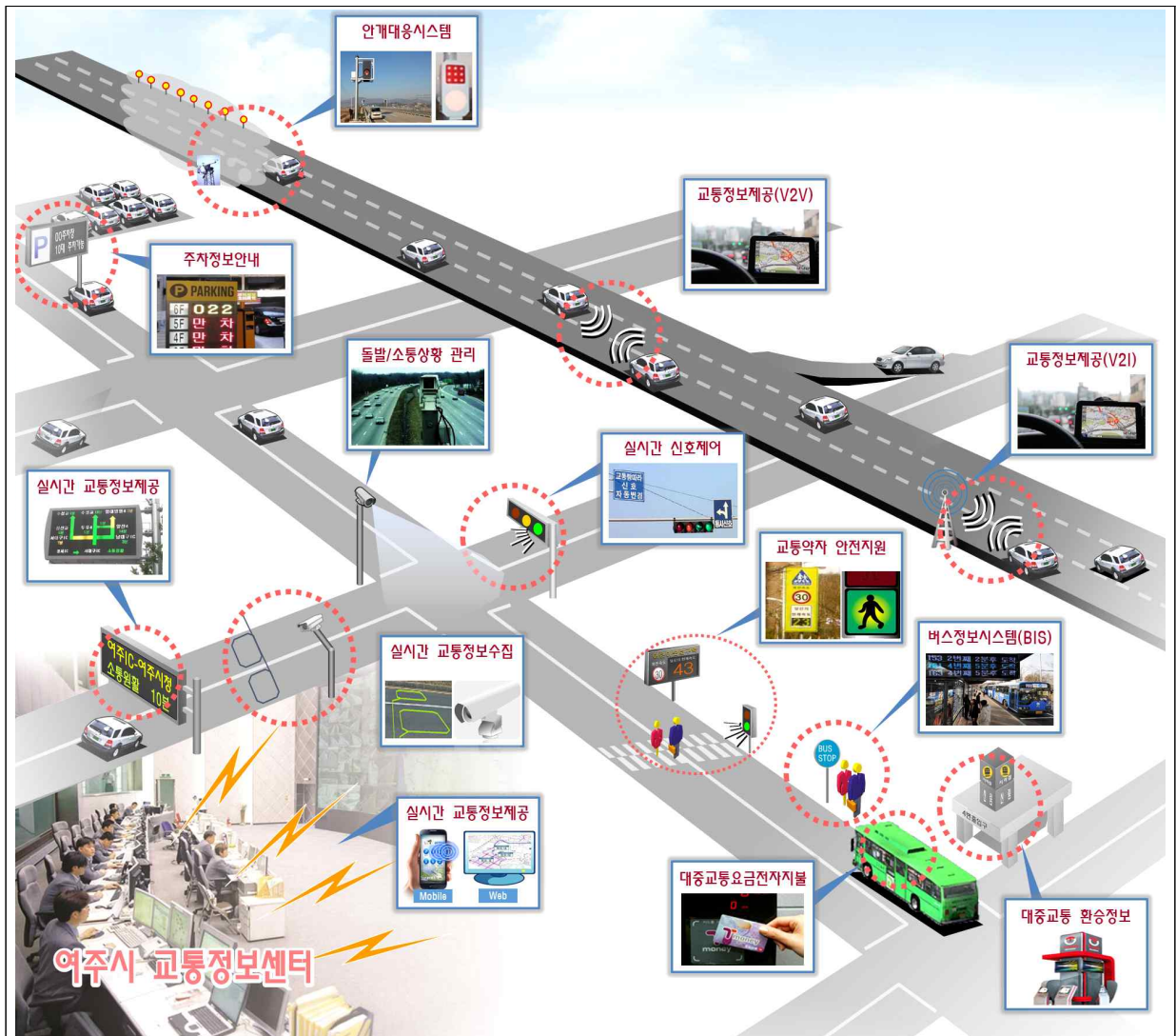
<그림 5-1> 여주시 ITS 시스템 개요
