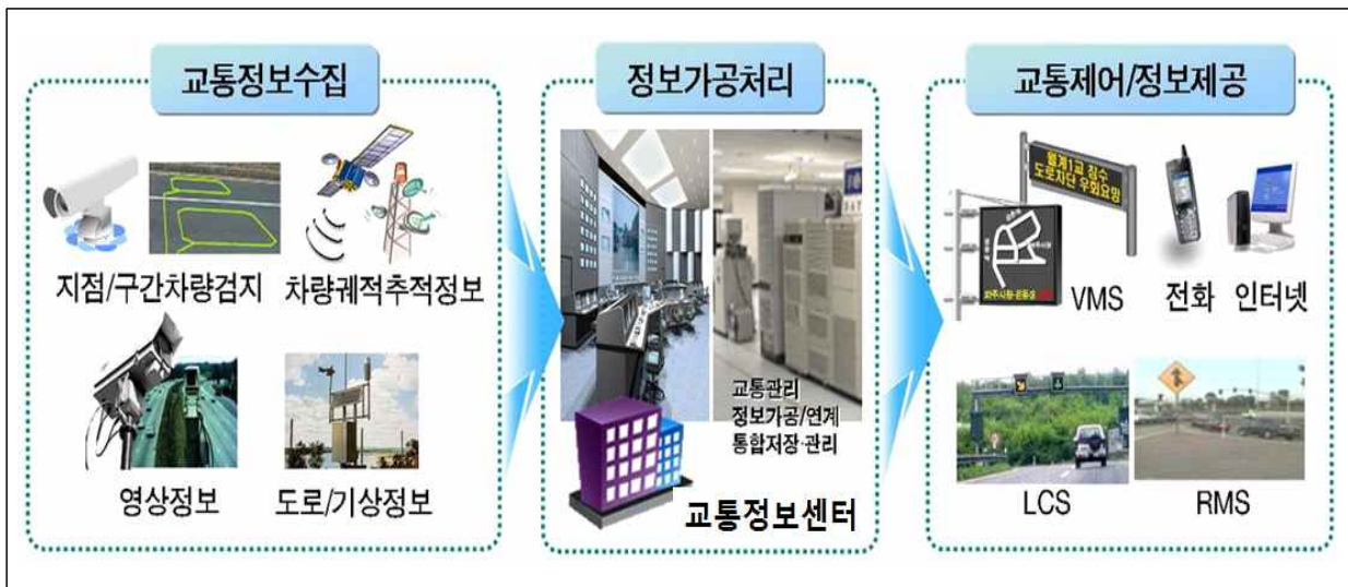
<그림 5-27> 교통정보제공시스템 개념도
