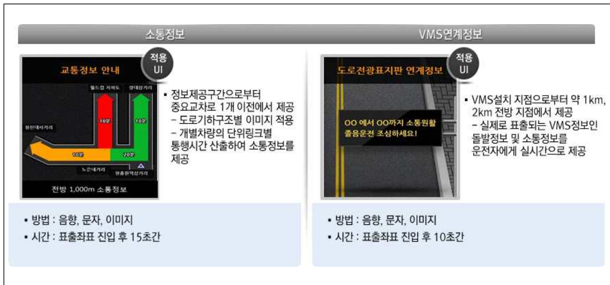
<그림 3-16> 위치기반 교통정보 제공 시스템 개념도
