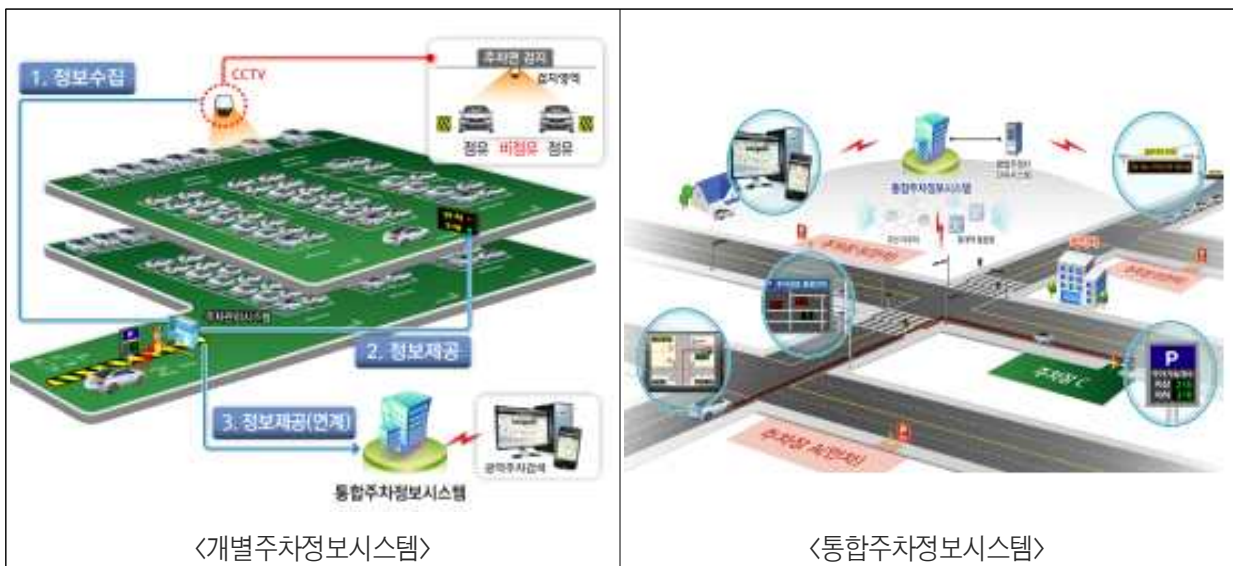
<그림 3-1> CCTV를 활용한 주차정보시스템 개념도
