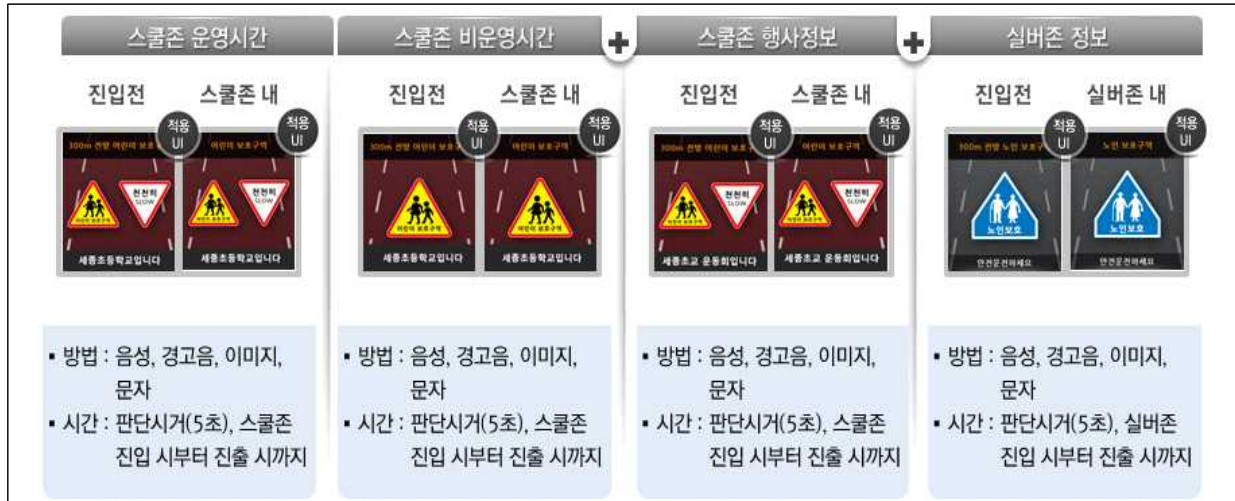
<그림 3-25> 스쿨존·실버존 속도 제어 시스템 개념도
