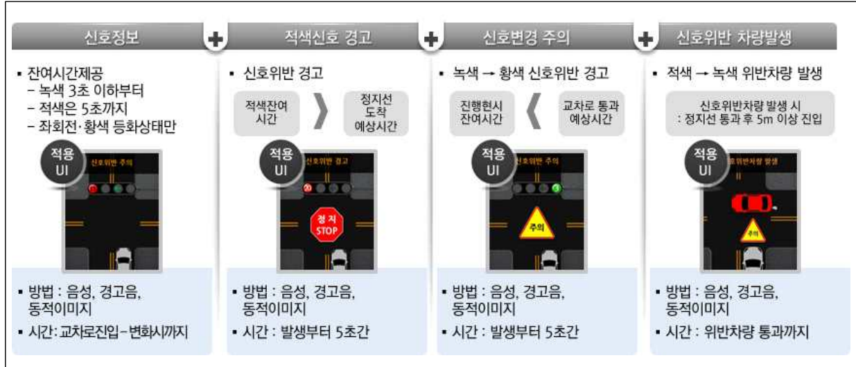
<그림 3-21> 신호위반 위험 경고 시스템 개념도
