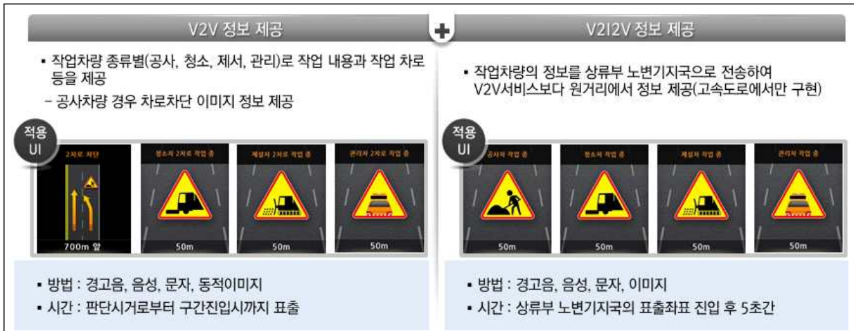
<그림 3-20> 도로 작업구간 주행 지원 시스템 개념도
