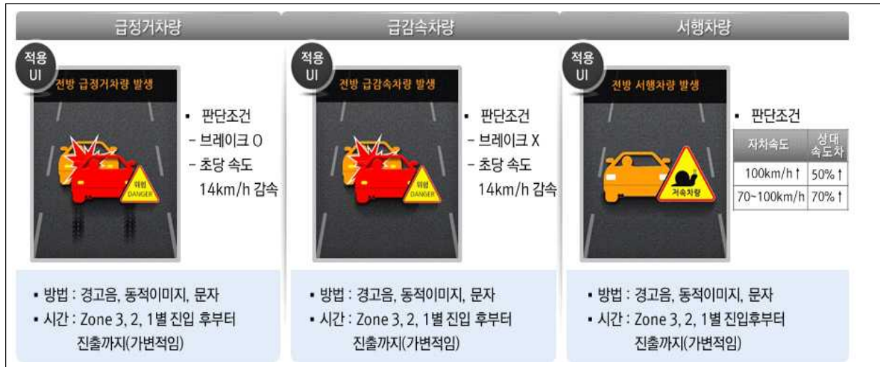
<그림 3-27> 차량 충돌방지 지원 시스템 개념도
