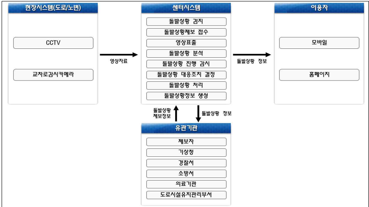
<그림 5-21> 돌발상황관리시스템 구성체계
