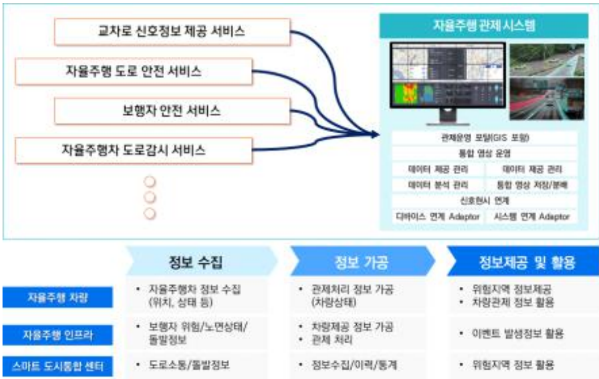
<그림 5-25> 자율주행 관제시스템 아키텍처
