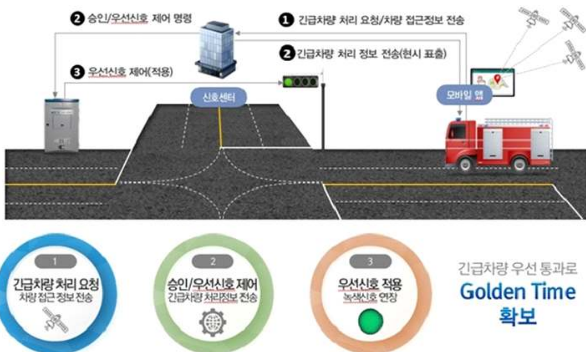
〈그림 6-31〉 긴급차량 우선신호 센터 제어방식 개념도(대전시)
