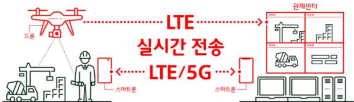
〈그림 6-47〉 SK텔레콤의 실시간 영상전송방식 개념
