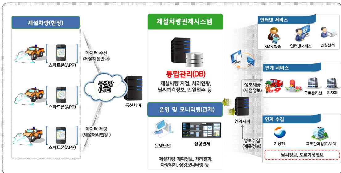
[그림 7-61] 강원도 제설차량 관리시스템 구성도
