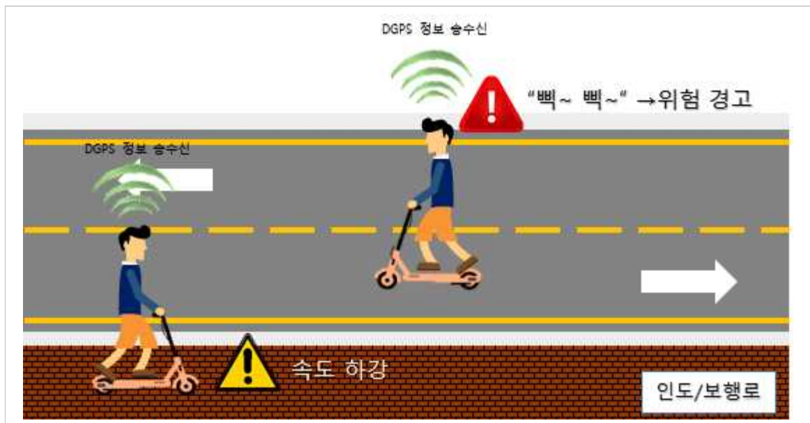
[그림 7-20] DGPS 기반 역주행 방지 및 자동감속 시스템 개념도
