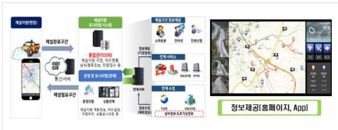
[그림 7-59] 제설차량 모니터링 시스템 구축 개념도
