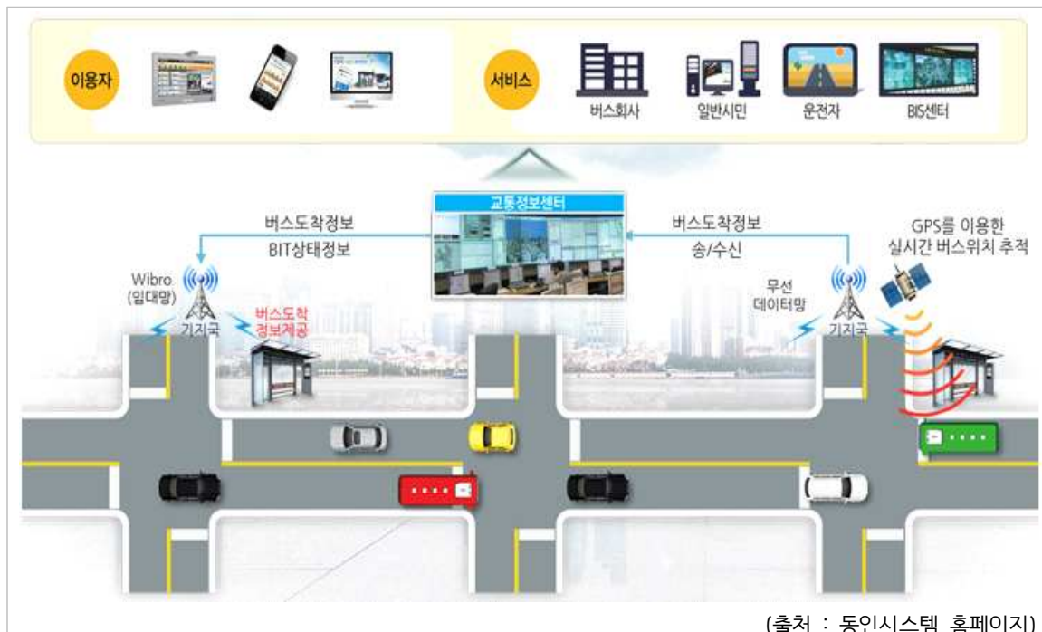
[그림 2-30] 버스정보시스템(BIS) 개념도
