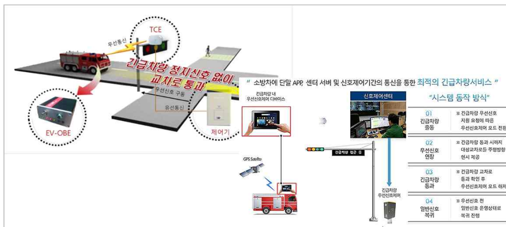
[그림 7-39] 긴급차량 우선신호시스템 개념도
