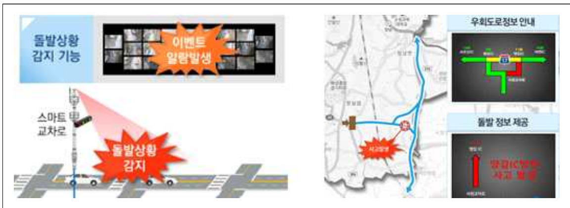
[그림 7-6] 경기도 돌발정보 연계 시스템 개념도
