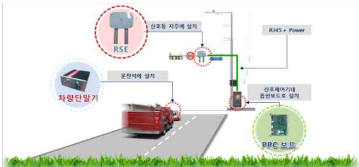
[그림 4-21] 긴급차량 우선신호 시스템
