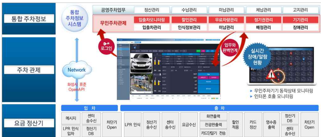
[그림 7-25] 주차통합 관리시스템 개념도
