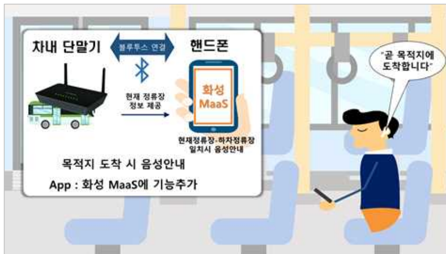
[그림 7-23] MaaS 연동 버스 도착지 안내 서비스 개념도
