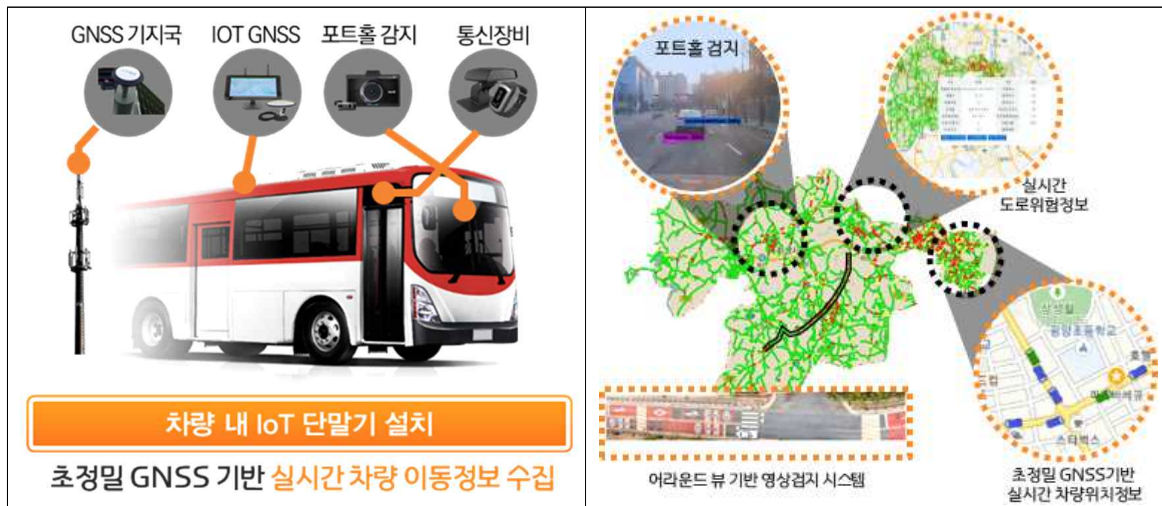
[그림 7-57] GNSS 기반 실시간 도로 위험상황 정보수집 현장시스템 개념도
