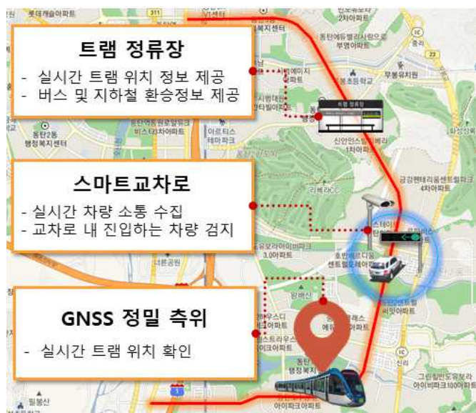
[그림 7-74] 트램 현장 시스템 구축(안)
