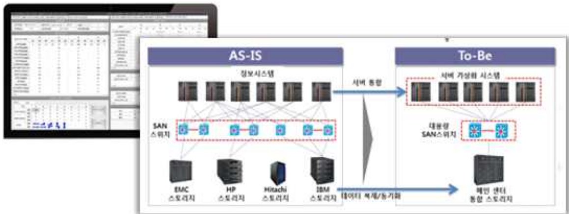
[그림 7-43] 신호제어시스템 가상화서버 구축 개념도
