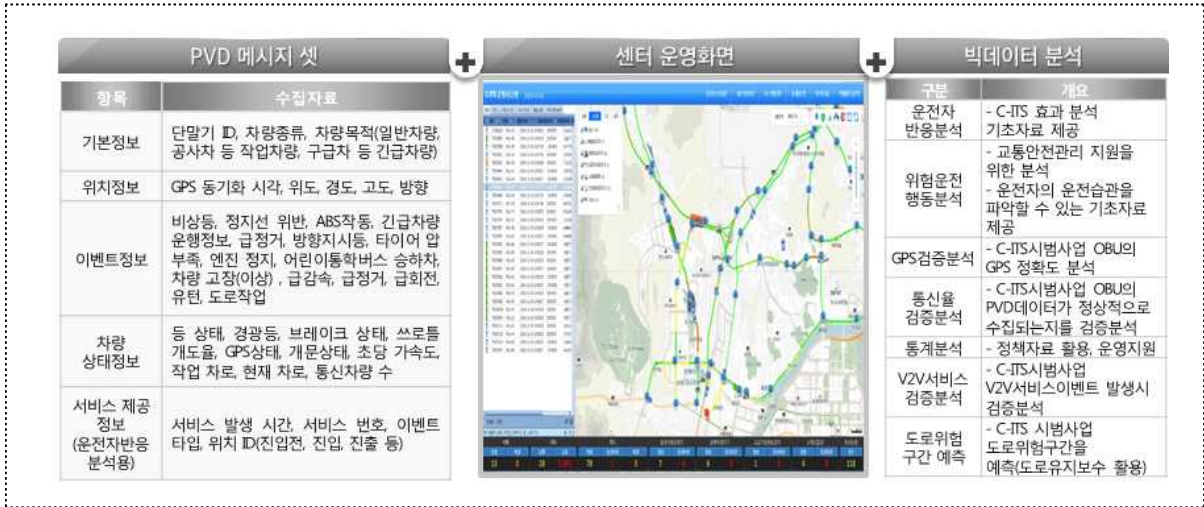
〈그림 3-6〉 위치기반 차량데이터 수집 시스템 구성도
