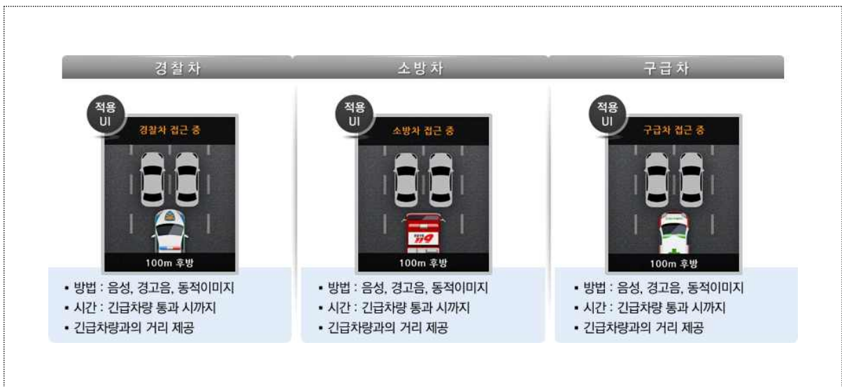
〈그림 3-19〉 긴급차량 접근 경고 시스템 개념도
