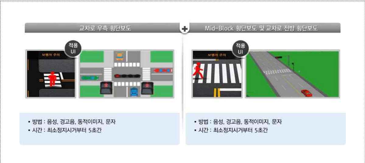
<그림 3-17> 보행자 충돌방지 경고 시스템 개념도
