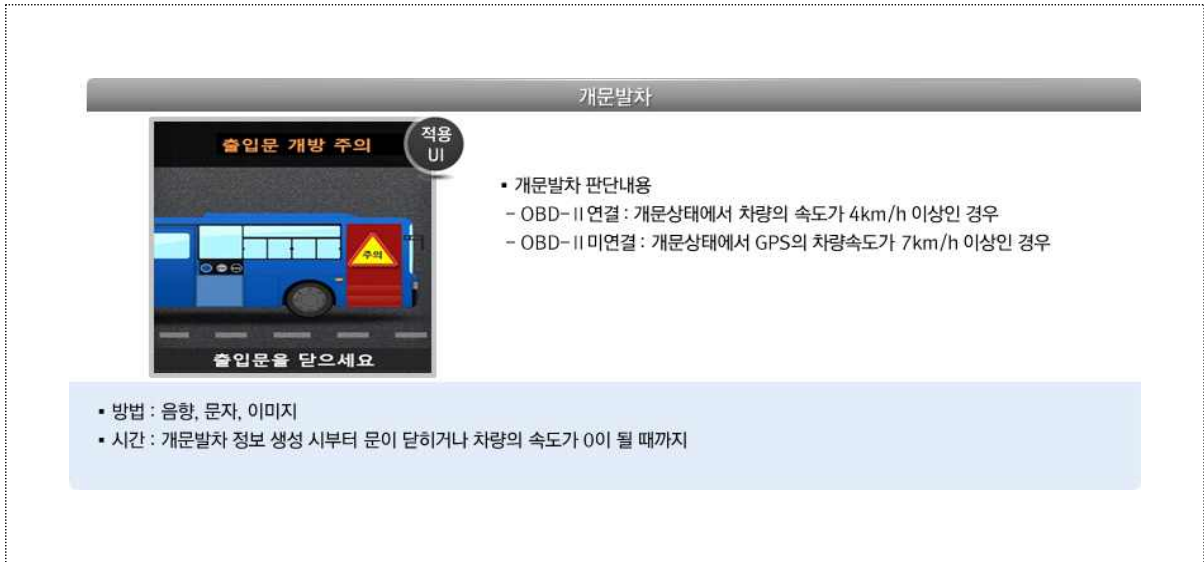
〈그림 3-14〉 버스 운행관리 시스템 개념도
