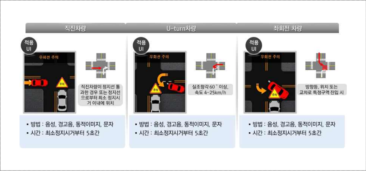
〈그림 3-13〉 우회전 안전운행 지원 시스템 개념도
