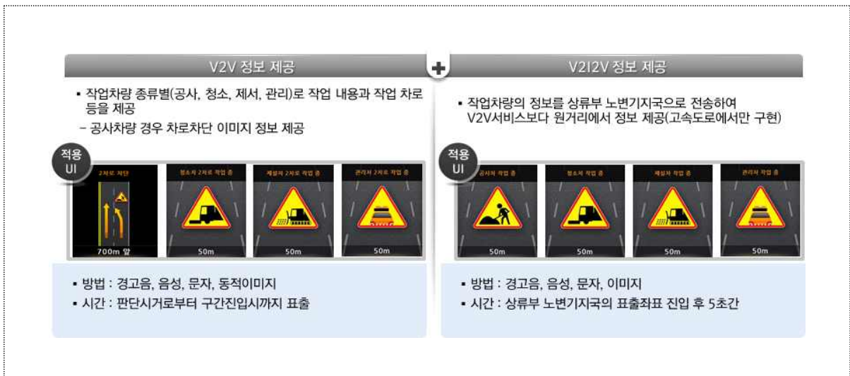
〈그림 3-11〉 도로 작업구간 주행 지원 시스템 개념도
