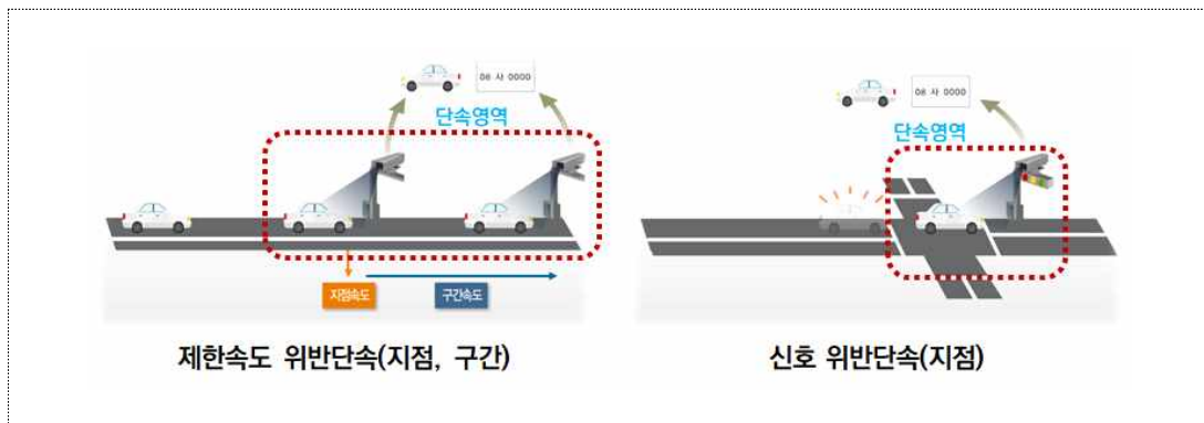
〈그림 5-32〉 속도/신호단속시스템 개념도
