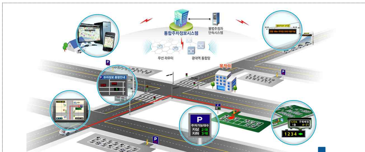
〈그림 5-24〉 주차정보제공시스템 개념도
