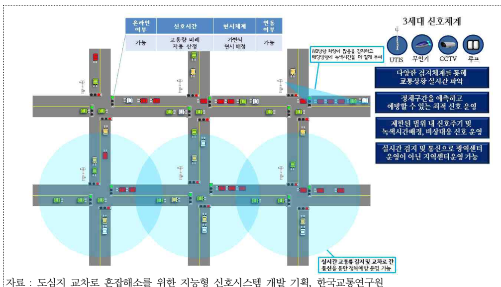
〈그림 5-5〉 스마트신호제어시스템 개념도
