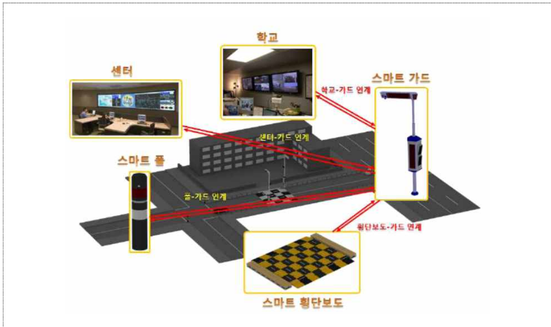
〈그림 3-30〉 스쿨존 통행안전 통합시스템 구성도
