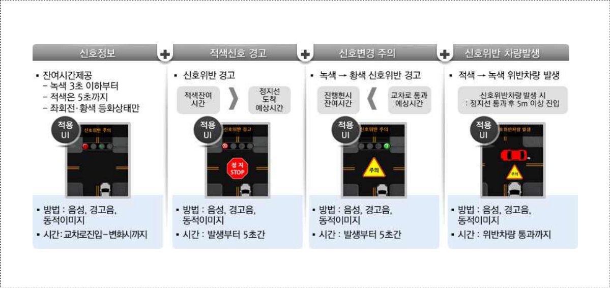
〈그림 3-12〉 신호위반 위험 경고 시스템 개념도
