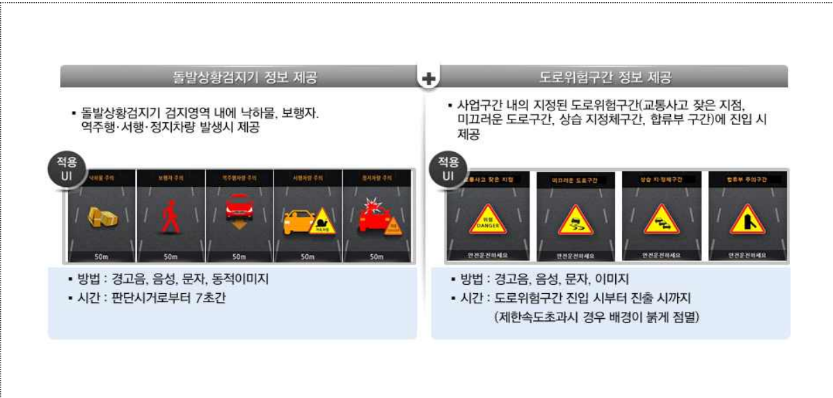
〈그림 3-9〉 도로 위험구간 정보제공 시스템 개념도
