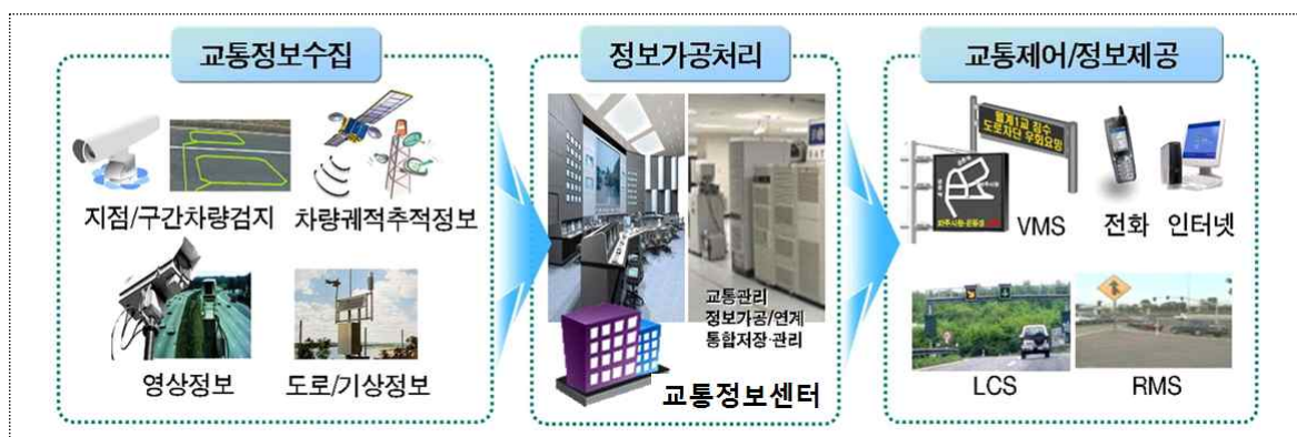
〈그림 5-16〉 교통정보제공시스템 개념도
