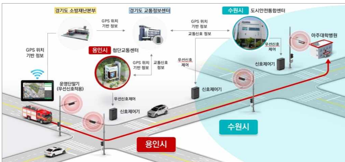
[그림 6-19] 광역 긴급차량 우선신호시스템 개념도
