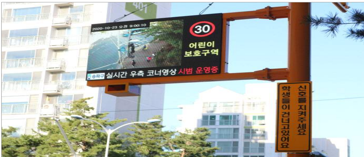
[그림 6-49] 송파구 실시간 우회전 영상알리미
