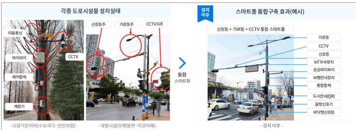
[그림 3-32] 서울시 스마트폴(Smart Pole)
