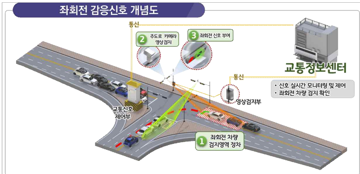
[그림 3-48] 스마트 감응신호시스템 개념도
