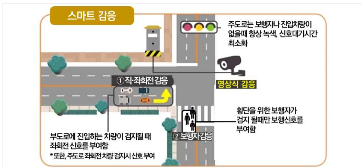
[그림 6-8] 스마트 감응신호시스템 개념도
