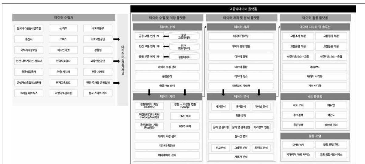
[그림 3-38] 교통빅데이터 플랫폼 목표 시스템 구성도
