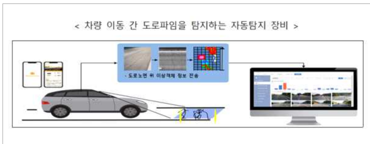
[그림 6-26] 도로노면탐지시스템 개념도
