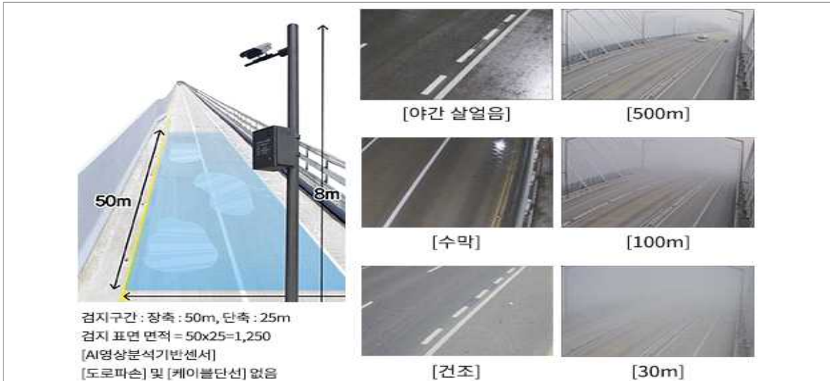
[그림 6-61] AI 영상기반 도로노면 복합검지장치
