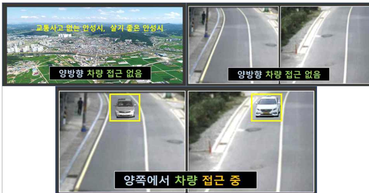
[그림 6-47] 교차로진입 안전시스템 VMS 표출화면 예시
